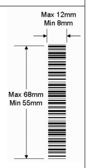
Min 1mm Min 1mm Min 8mm
